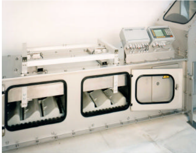
Wägebrücke, Steuerung und Anzeigegerät
